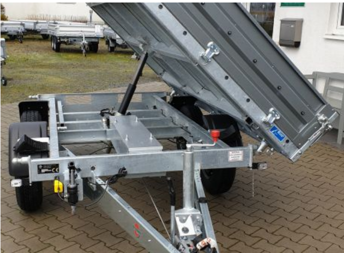
Stema Trius Dreiseitenkipper 3500kg 2mm Stahl Beplankung
